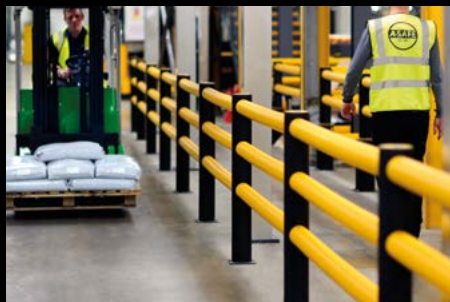
Zábrana pro chodce iFlex Pedestrian Barrier odděluje dopravu a chrání chodce v průmyslovém objektu.
